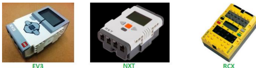
图 20 允许使用的控制器的外形
